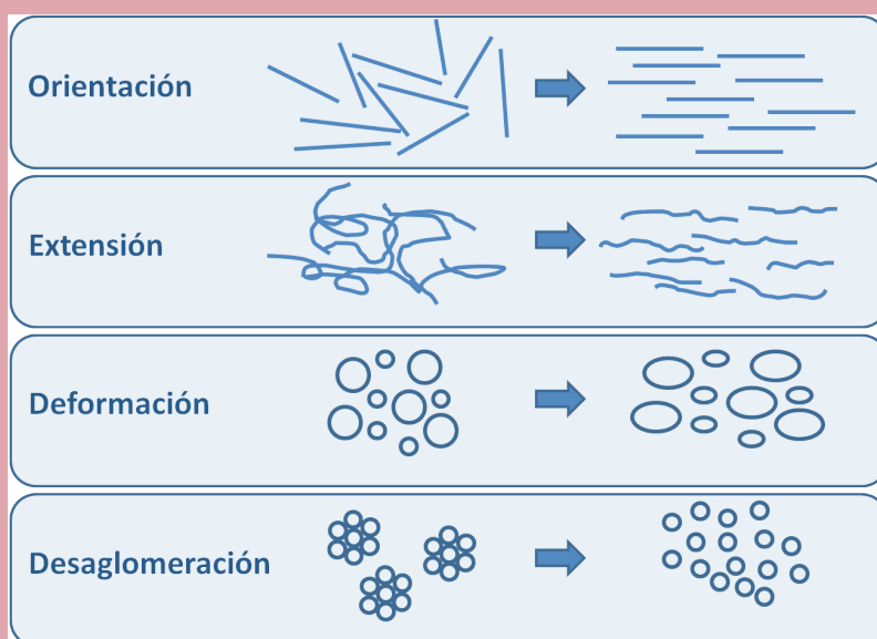
Figura 4. Comportamiento espacial de macromoléculas sometidas a cizalla.
