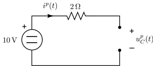
**Figura 1.25.** Circuito en régimen permanente de corriente continua.
