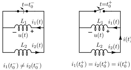
**Figura 1.22.** Conexión de dos bobinas en serie.
