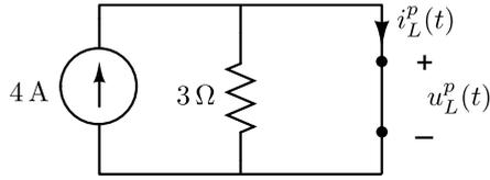
**Figura 1.28.** Circuito en régimen permanente de corriente continua.
