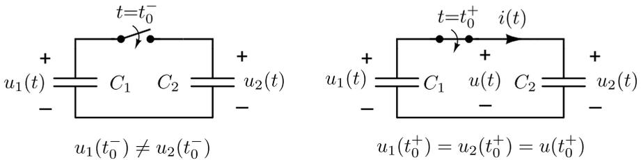
Figura 1.21. Conexión de dos condensadores en paralelo.
