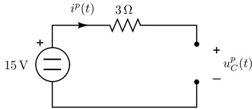
**Figura 1.16.** Circuito en régimen permanente de corriente continua.
