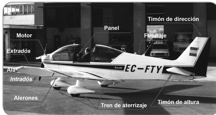
Figura 2.1. Partes principales de un avión.
