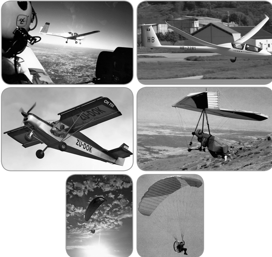
Figura 1.2. Alas fijas (avión, planeador, ultraligero, ala delta y parapente sin motor y motorizado).
