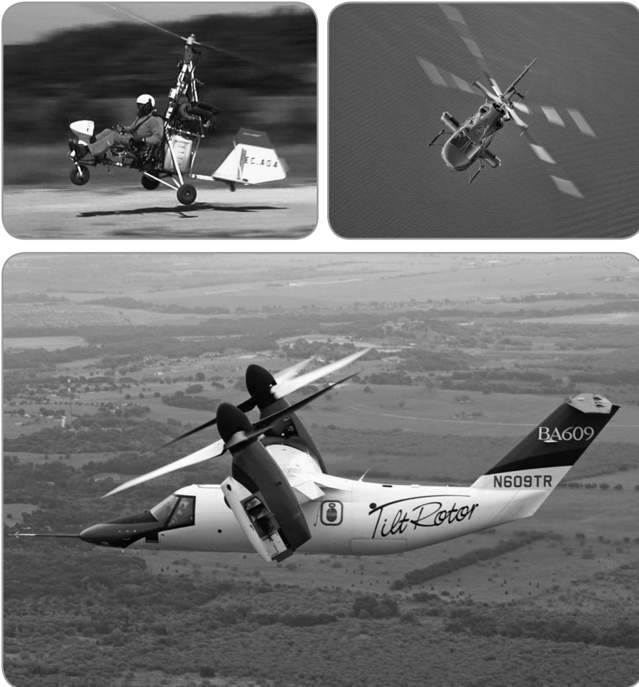
Figura 1.3. Alas rotatorias (autogiro, helicóptero y rotor orientable –tilt rotor).
